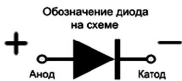
При совмещении полупроводников *p*-типа и *n*-типа возникает пограничная область, называемая ***p-n* переходом** (или электронно–дырочным переходом), основным свойством которого является способность проводить ток преимущественно в одном направлении.
