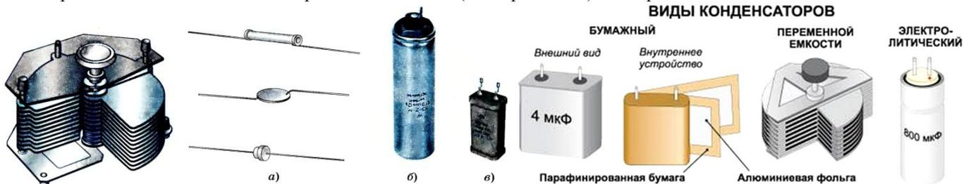
Внешний вид различных типов конденсаторов
