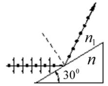
4.24 Под каким углом надо направить пучок света от фонарика, чтобы его лучи, отражённые от поверхности стекла, были полностью линейно поляризованы? Показатель преломления стекла равен 1,5
