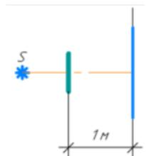
3.18 Горизонтальный луч падает на плоское вертикально расположенное зеркало. На какой угол необходимо повернуть зеркало вокруг вертикальной оси, чтобы отраженный луч повернулся на  $30^\circ$ ?
